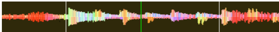
Figure 1: Una ona d'àudio a un nivell correcte. Tingueu en compte que els gràfics d'ona d'aquesta secció s'han fet ajustant el guany visual del mateix al Mixxx per intentar descriure els conceptes. Canviar el guany visual del gràfic d'ona no canvia el nivell de l'àudio.
